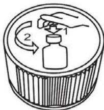
Para abrir o frasco é preciso pressionar a tampa para baixo e girar ao mesmo tempo, mantendo-a pressionada. Feche firmemente após o uso.
